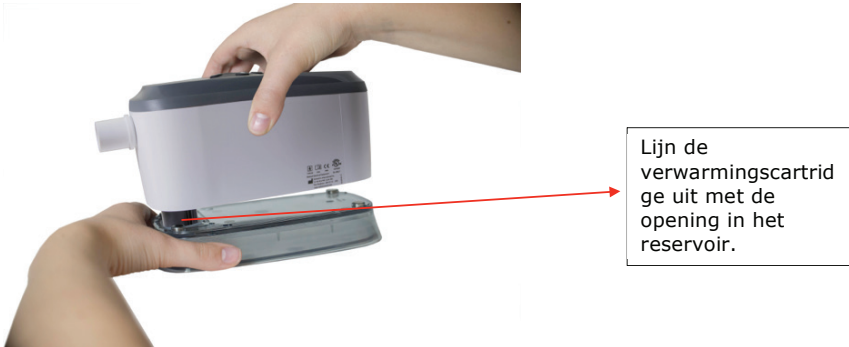
Figuur 1 Lijn de verwarmingscartridge uit met de opening in het reservoir. Laat het apparaat op het reservoir zakken. Magneten zullen zich vastzetten om de twee delen bij elkaar te houden.
